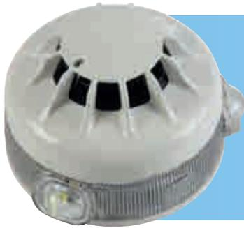
I VAD a soffitto sono indicati per un'ampia copertura in stanze di forma regolare. Possono essere utilizzati come alternativa ai dispositivi montati a parete e sono più pratici da installare in grandi aree aperte poiché possono essere combinati con dispositivi di rivelazione. Tuttavia è più probabile che siano influenzati da livelli di luce ambientale elevati.
